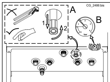
**!** Centrala este dotată cu presostat hidraulic care în caz de lipsă a apei nu admite funcționarea centralei.
