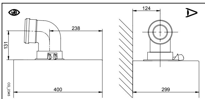
Закрепите приточные воздуховоды с помощью двух оцинкованных винтов диаметром Ø 4,2 мм и длиной не более 19 мм.
