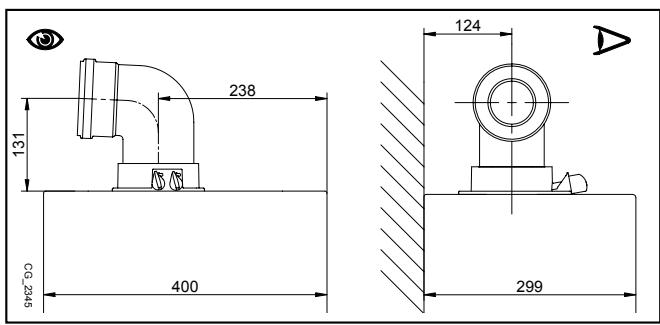
Στερεώστε τους σωλήνες αναρρόφησης με δύο βίδες ψευδαργυρωμένες Ø 4,2 mm και μέγιστου μήκους 19 mm.
