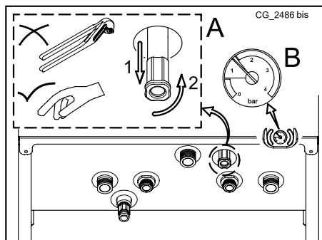
**!** La caldera está dotada de un presostato hidráulico que no permite el funcionamiento de la caldera en caso de falta de agua.
